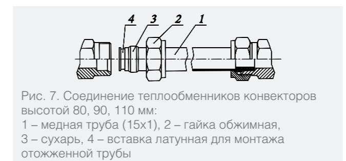
Рис. 7. Соединение теплообменников конвекторов высотой 80, 90, 110 мм: 1 – медная труба (15x1), 2 – гайка обжимная, 3 – сухарь, 4 – вставка латунная для монтажа отоженной трубы
