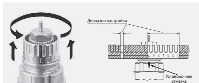
Рис. 11. Предварительная настройка клапана Danfoss
